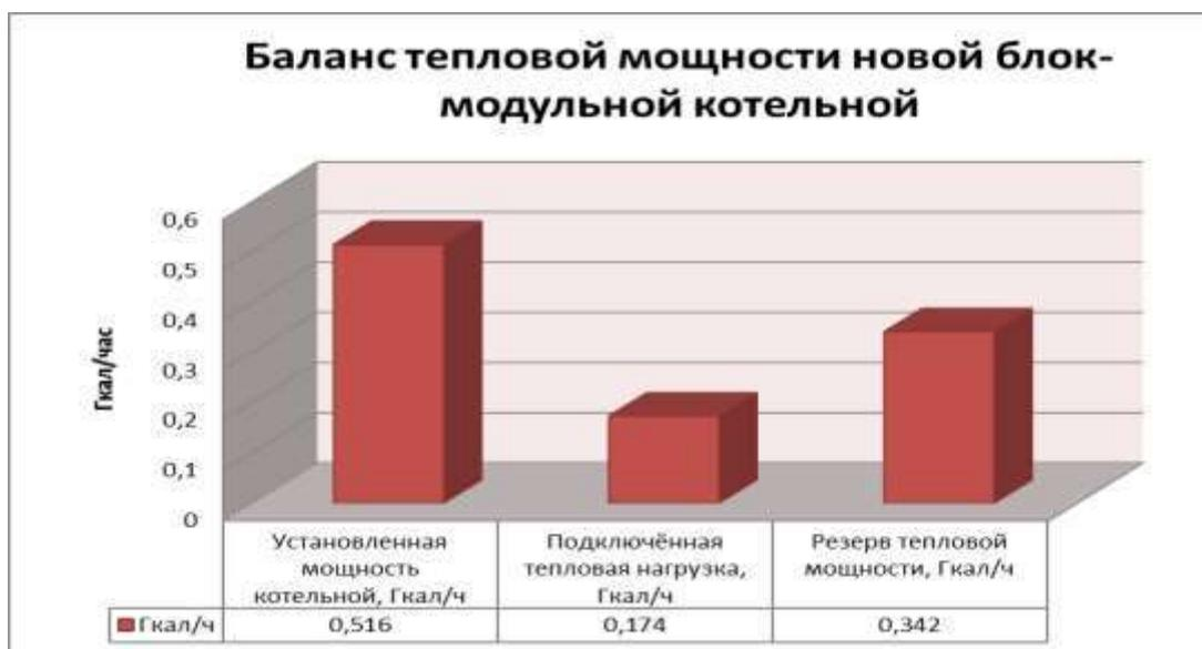
Рисунок 3.2. Баланс мощности новой котельной, Гкал/час.
